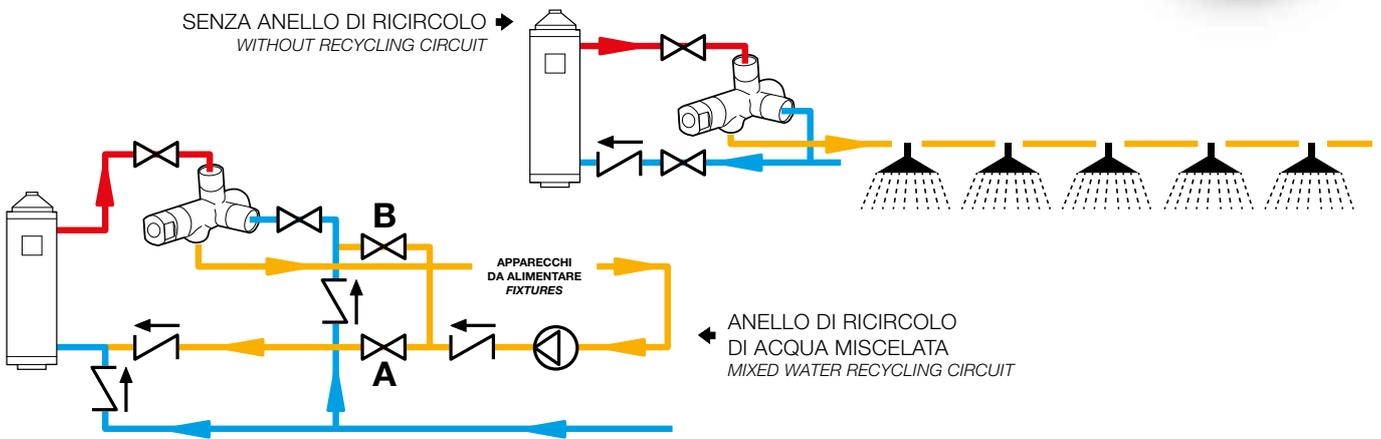
A 3 bar si possono alimentare 4/5 docce utilizzando i limitatori di portata RIVER 280/9 montati fra il braccio e il soffione doccia.
