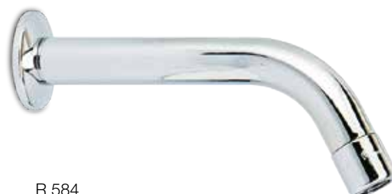
R 584 Fissa a parete Ø 28 - mm 215 consumo 7 litri/minuto wall installation
