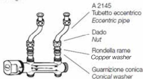
Per il montaggio spingere a fondo i 2 tubetti cromati fino alla battuta interna.
